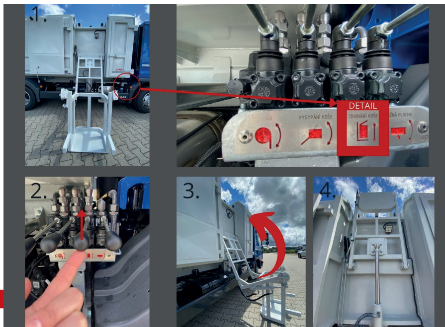
Obrázek 14. zdvihání hydraulického bočního podavače
