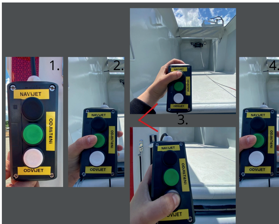
Obrázek 12. manipulace s navijákem za pomoci dálkového ovládání
