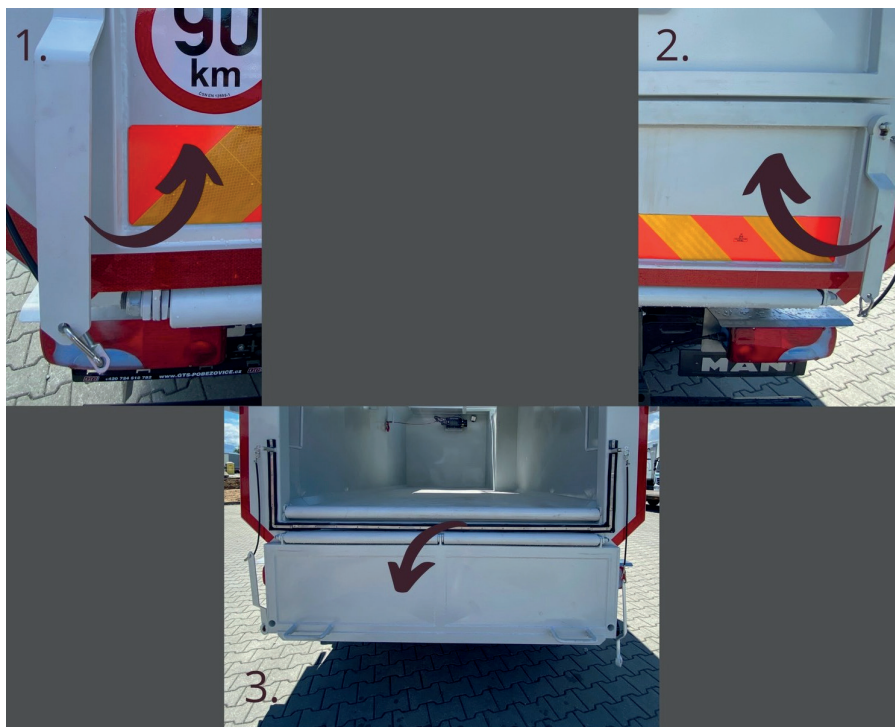
Obrázek 7. manipulace s odklopným čelem ve svislé poloze
