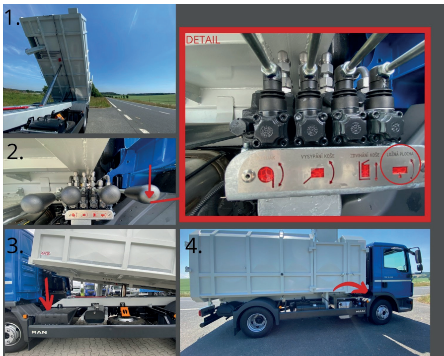
Obrázek 5. manipulace s korbou nástavby - sklápění korby
