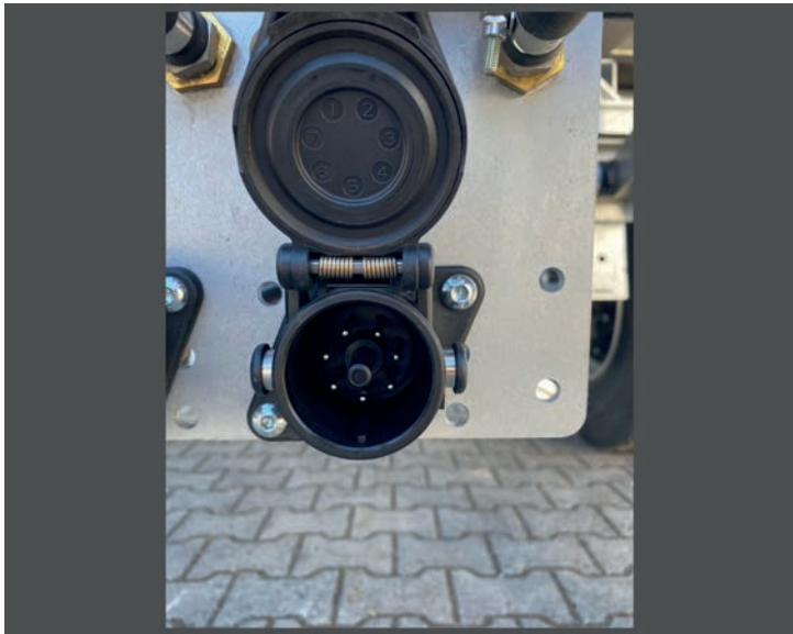
Obrázek 12. konektor ISO 7638 pro propojení el. napájení a ovládání brzd
