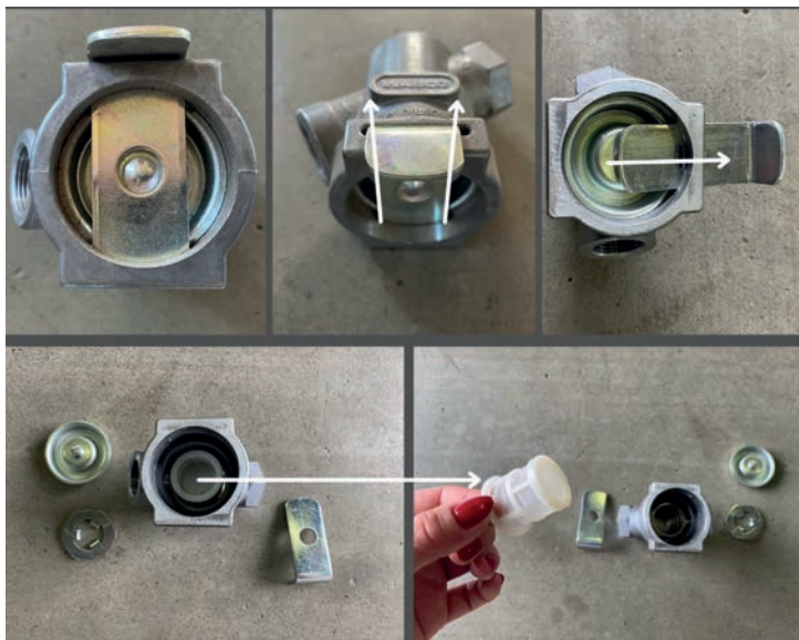
Obrázek 18. filtry pneumatického vedení/ filtr vložený do vedení při DUOMATIC/filtr integrovaný do spojovacích koncovek, schéma k čištění
