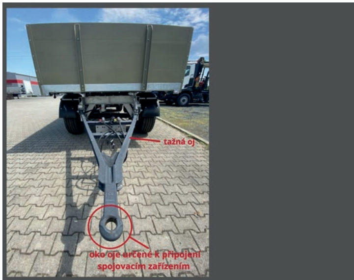
Obrázek 10. oko oje přívěsu určené k připojení spojovacím zřízením
