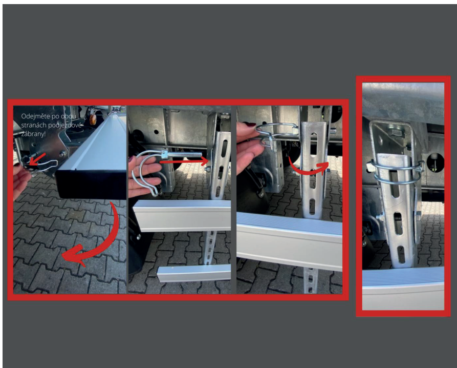
Obrázek 10 manipulace s boční podjezdovou zábranou – sklopení směrem dolů
