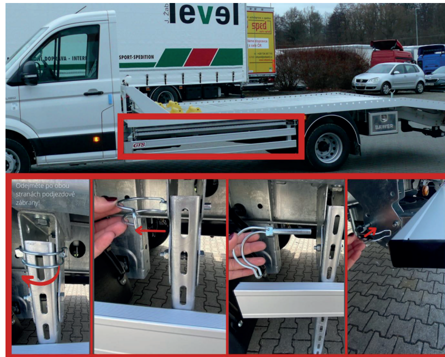
Obrázek 9 uložení nájezdů a manipulace s boční podjezdovou zábranou – odklopení směrem nahoru
